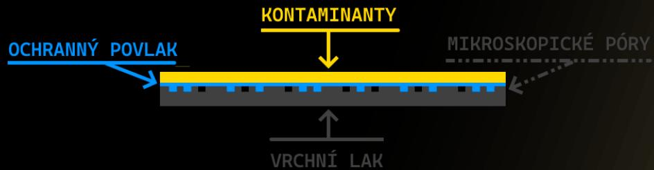
Nano keramický povlak **vytváří hladký a ochranný štít**, který **uzavírá mikroskopické póry** laku a **zabraňuje usazování nečistot a kontaminantů**.
