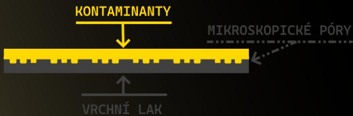
Znečištění a kontaminanty se zachycují v **mikroskopických pórech** laku, kde na ně postupně **ulpívají další nečistoty**. Dlouhodobé působení těchto nečistot **vede k narušení a poškození** laku.
